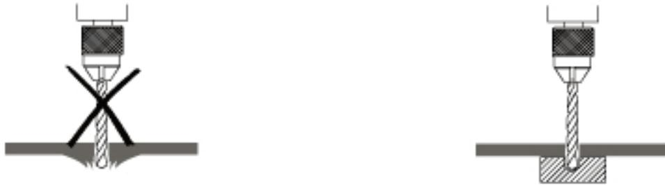
I fori di maggiori dimensioni, ad esempio per sistemi di sospensione e bloccaggio, devono essere effettuati con punte combinate.
